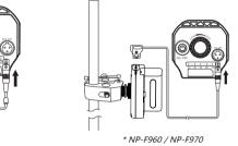
B) V-Mount/Anton Bauer 电池供电 4) 移动电源供电 (5V-2A)
